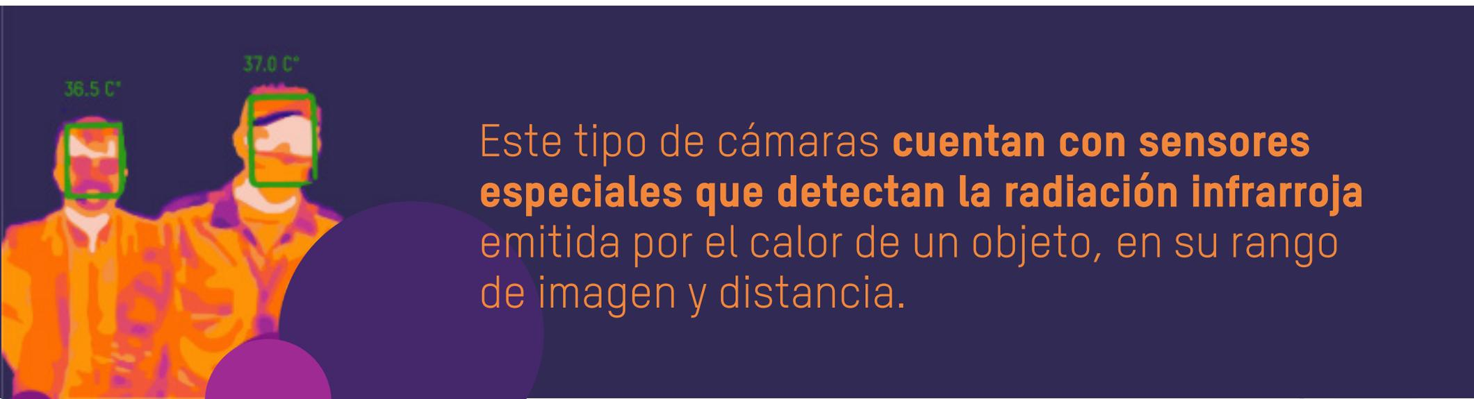
Este tipo de cámaras **cuentan con sensores especiales que detectan la radiación infrarroja** emitida por el calor de un objeto, en su rango de imagen y distancia.
